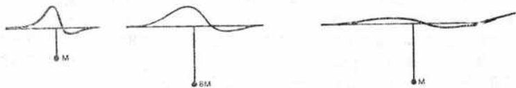
图 44 偶极子磁异常的深度/幅度特性
